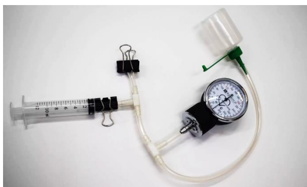
Рис. 3. Лабораторный комплект для изучения газовых законов Fig. 3. Laboratory kit for studying gas laws
